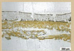
天衣の調査 -塗膜断面写真-
